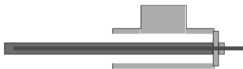
Placering af føler i følerør
